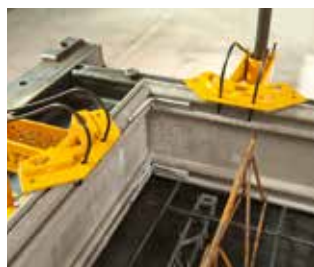
2. Mit Eckverbindern und Magneten befestigen
